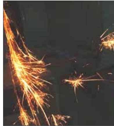
Abb. 3: Funkenbild; Eisen vom Gerschkogel
